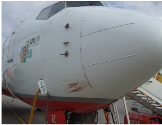
Vogelschlagspuren im Bereich der Rumpfnase
