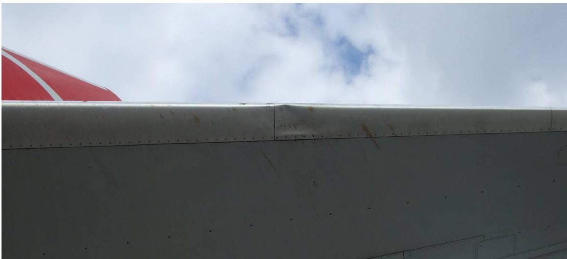
Beschädigung am linken Höhenleitwerk
