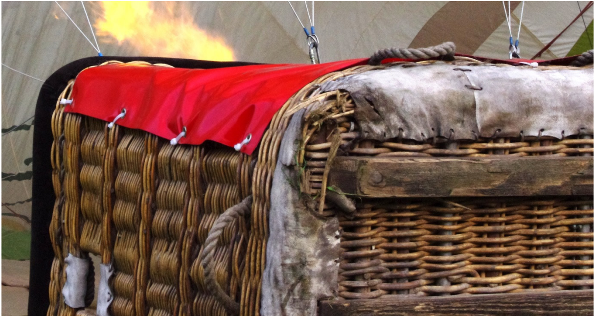
Sichtbar gebrochenes Geflecht am Korbboden (vor dem Start / Aufrüstvorgang)
