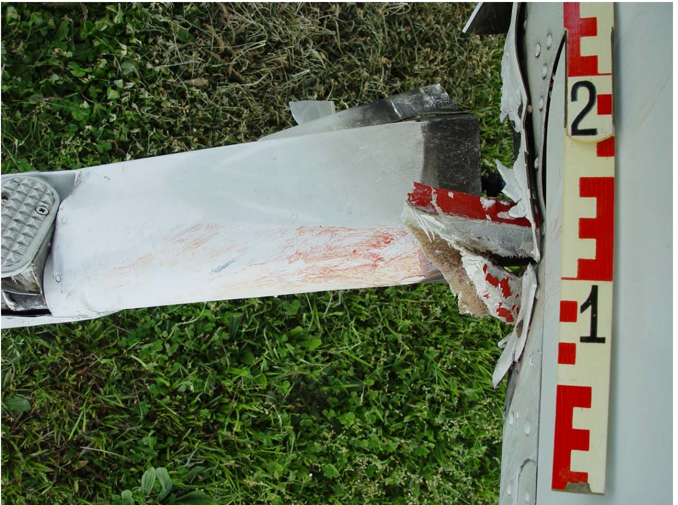
Bruchstücke vom linken Randbogen des Motorseglers in der rechten Fahrwerkaufnahme der Cessna
