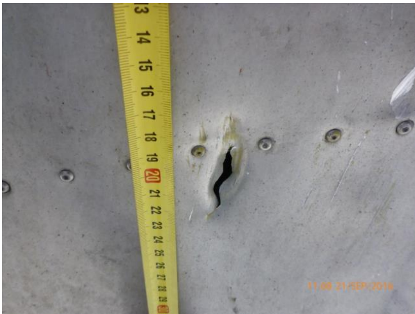
Beschädigung an der linken Landeklappe
