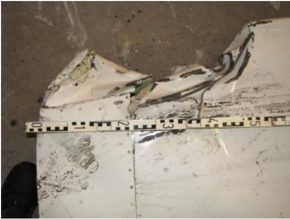
Schäden am Höhen- und Seitenleitwerk
