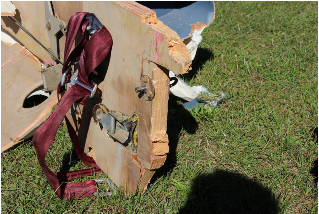
Bruchstelle der Tragfläche
