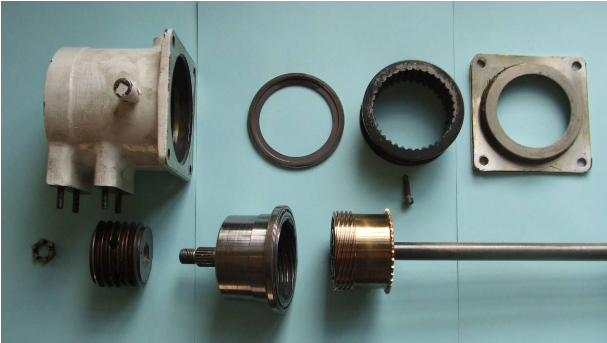
Verstellmechanismus der Heckrotorblätter zerlegt
