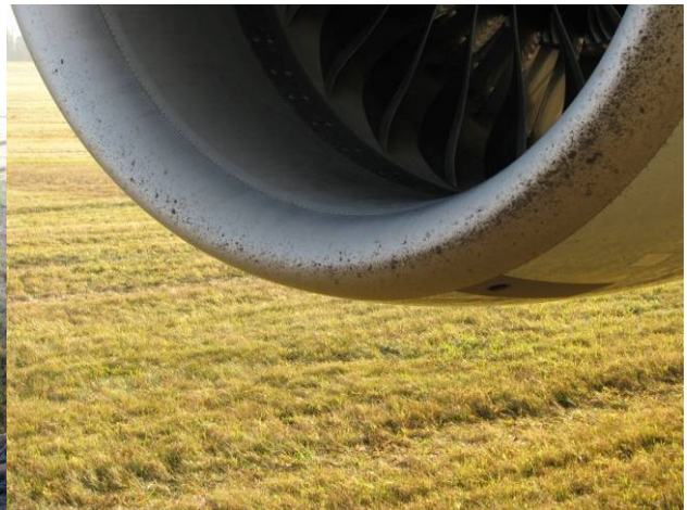
Verschmutzung am rechten Triebwerk
