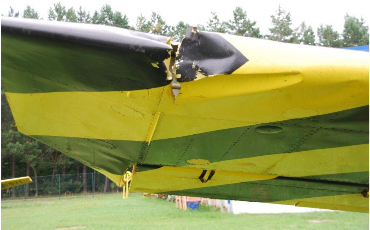
Kollisionsschaden am rechten Außenflügel
