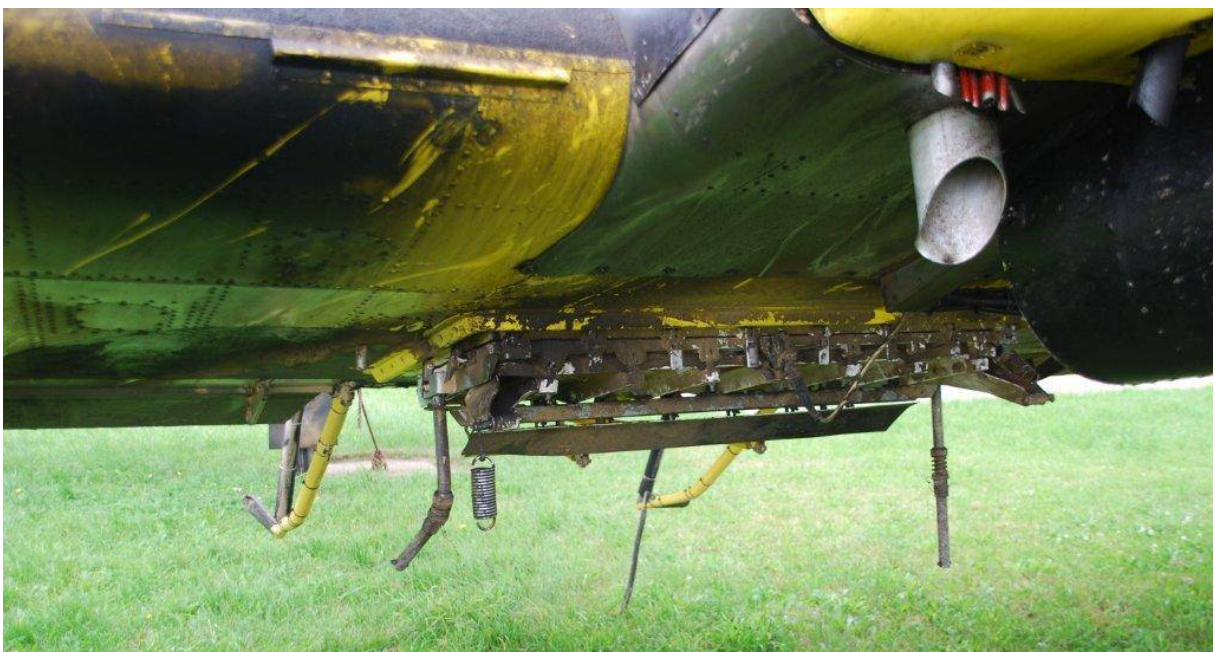
Kollisionsschäden an der Streuanlage
