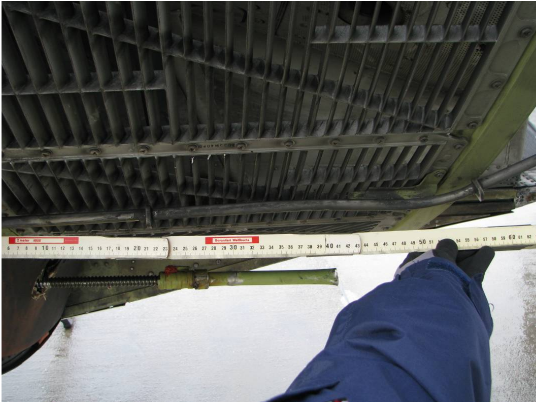
Bild 3: Ausgefahrener und gebrochener Kugelgewindetrieb
