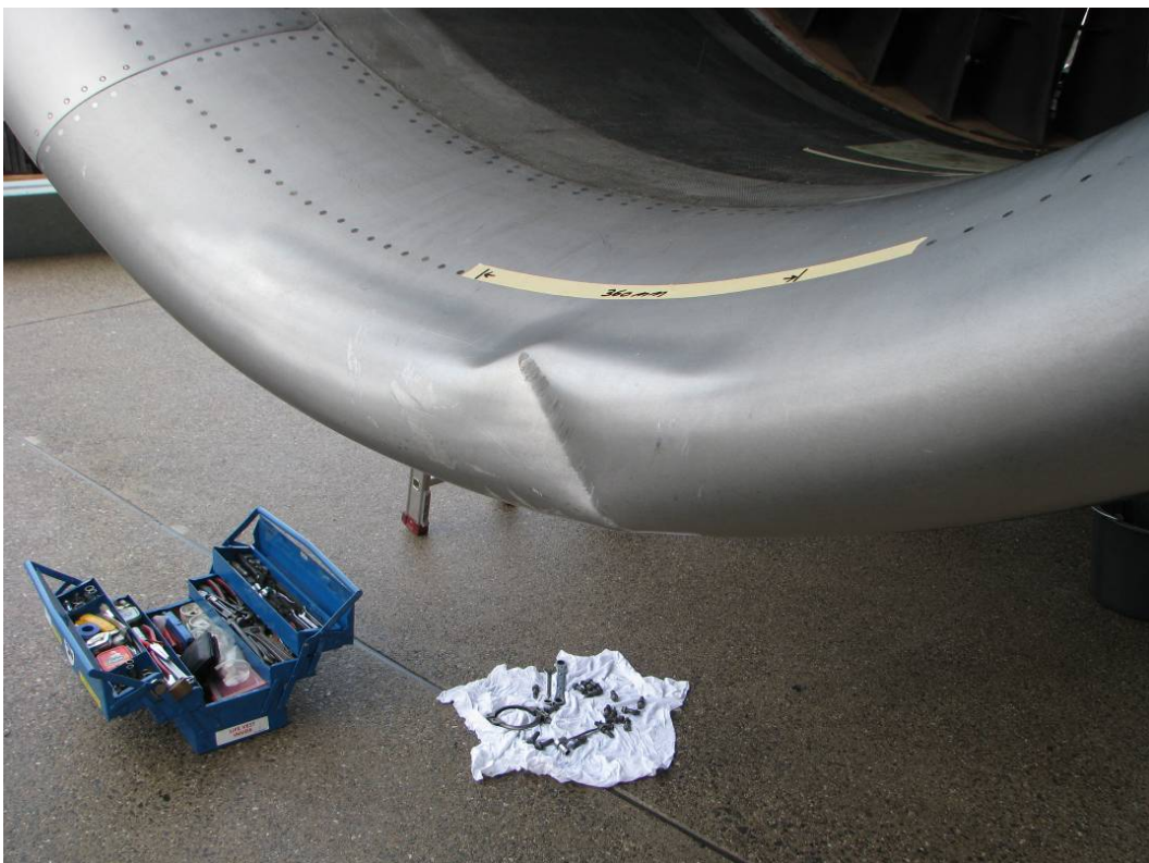
Bild 4: Verbeulter Lufteinlass rechtes Triebwerk des nachfolgenden Flugzeuges
