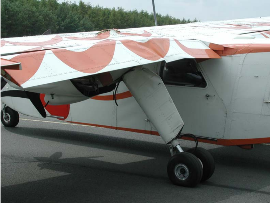
Beschädigungen am linken Hauptfahrwerk und an der linken Tragfläche
