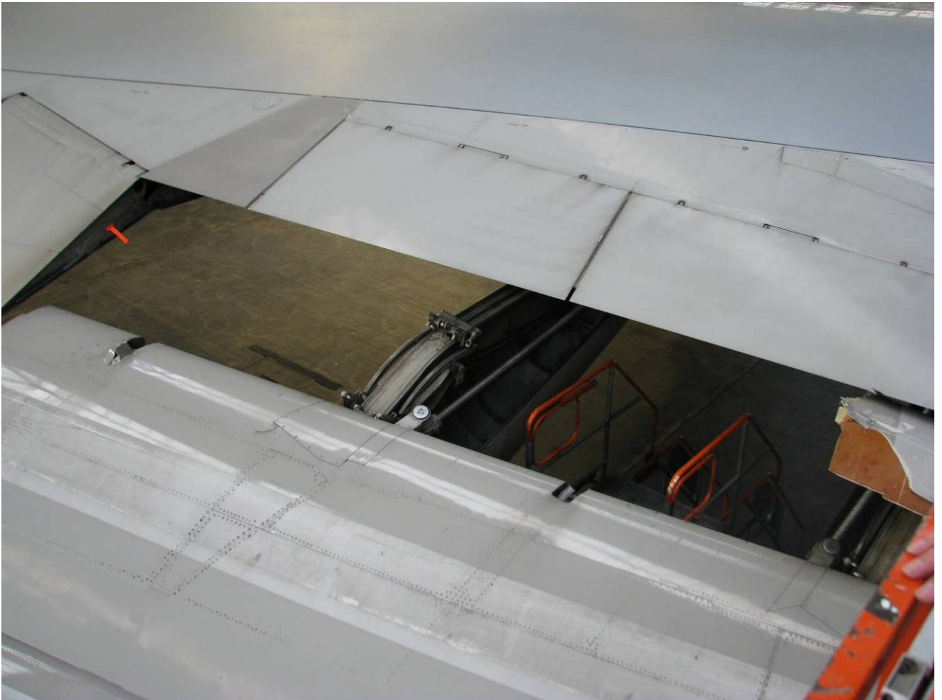
Anlage 1: Bereich der linken Tragfläche, in dem der Landeklappenteil fehlt.
