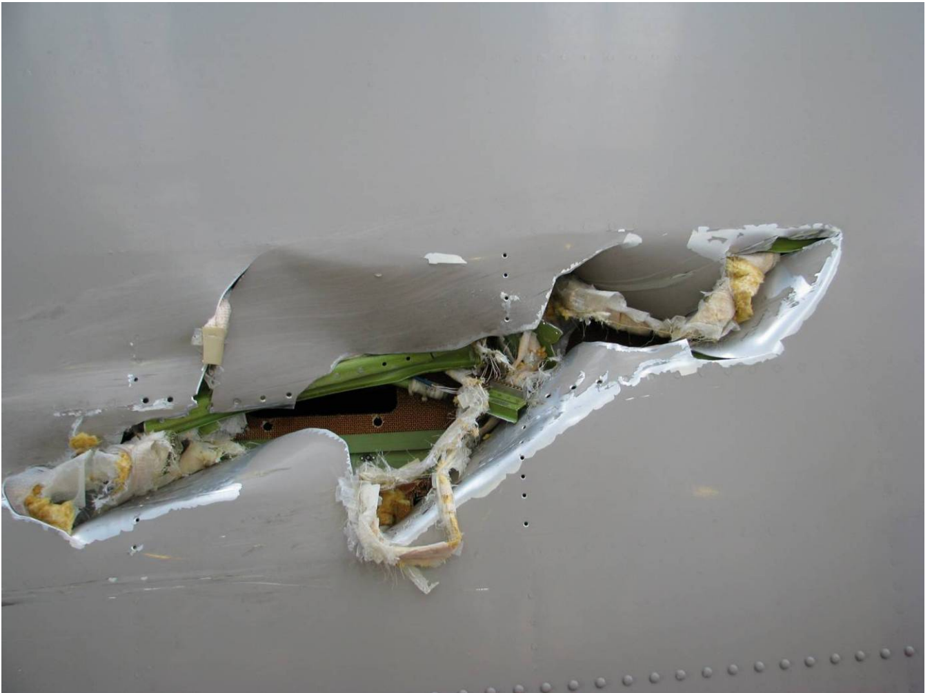
Anlage 4: Beschädigung am Rumpf
