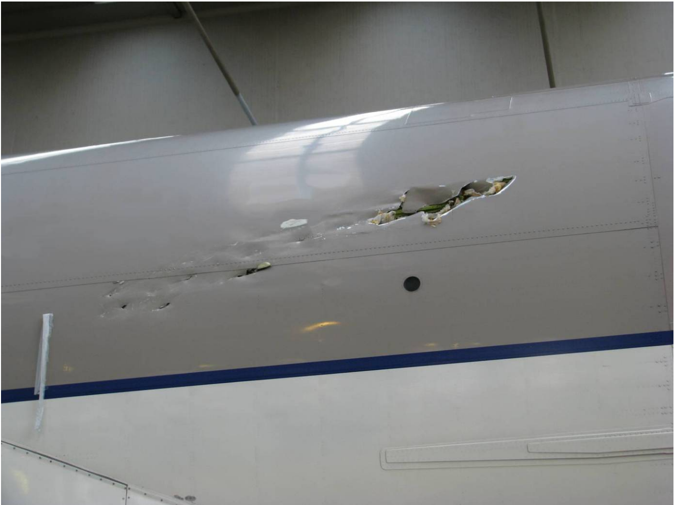
Anlage 3: Beschädigung am Rumpf
