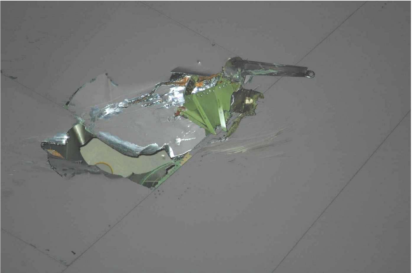
Anlage 6: Beschädigung am Seitenleitwerk
