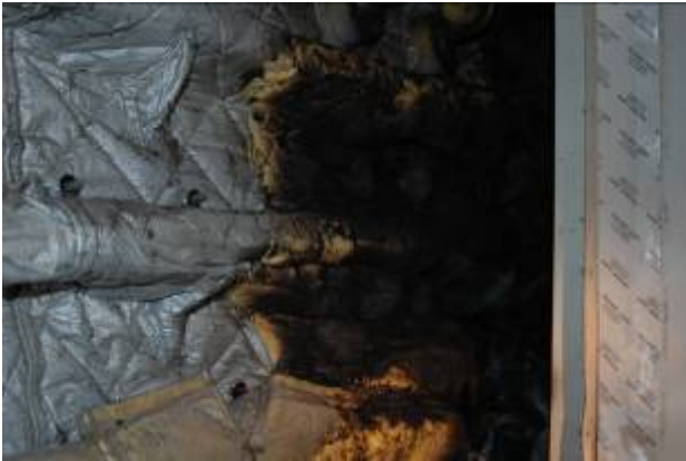
Verkohlte Isoliermatten (Bild oben und unten)
