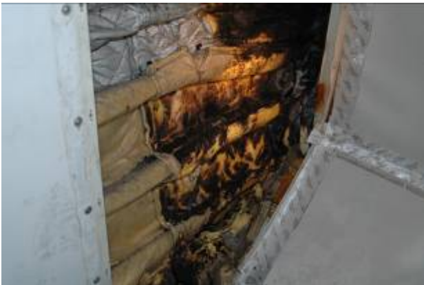
Verkohlte Isoliermatten (Bild oben und unten)
